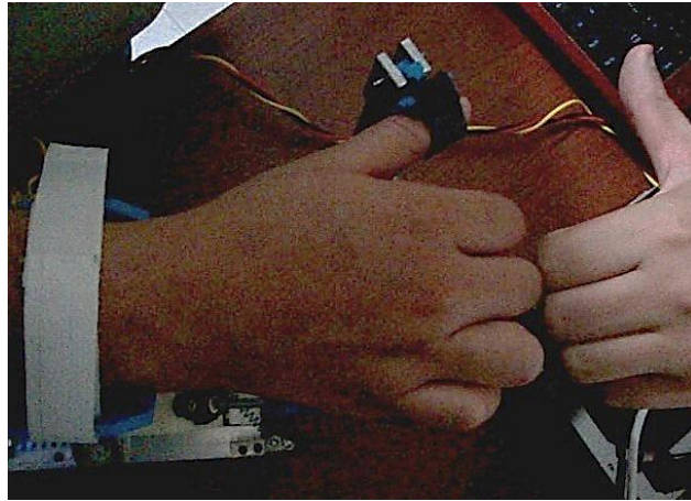
Figura 82. Comparación entre la abducción máxima del sistema y la abducción ideal del pulgar.
