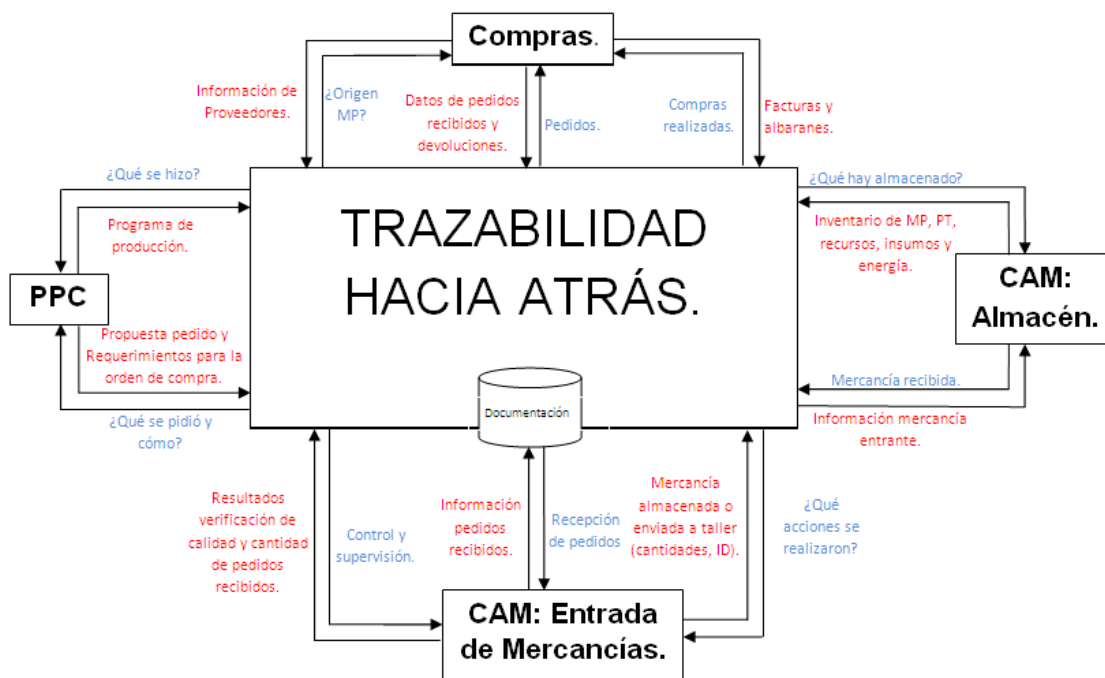
Ilustración 33. Flujos de Información Trazabilidad Hacia Atrás y Ámbitos del Modelo Siemens FIET.
