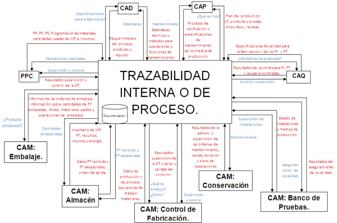
**Ilustración 19. Flujos de Información Trazabilidad Hacia Delante y Ámbitos del Modelo Siemens FIET.**
