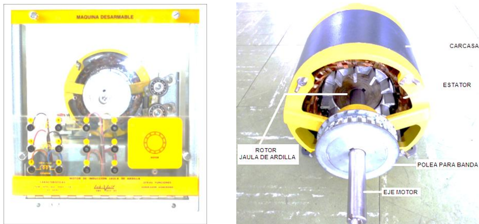
Figura 2 Motor de inducción trifásico con rotor jaula de ardilla
