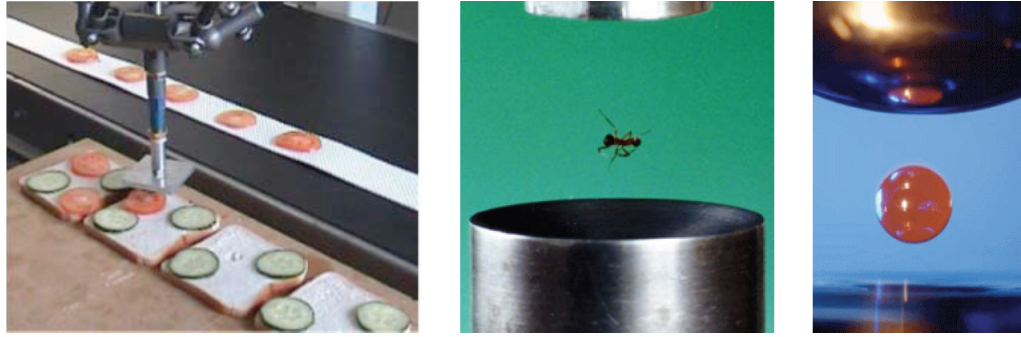
Figura 2: Aplicación de los sistemas de levitación neumática para la manipulación de objetos
