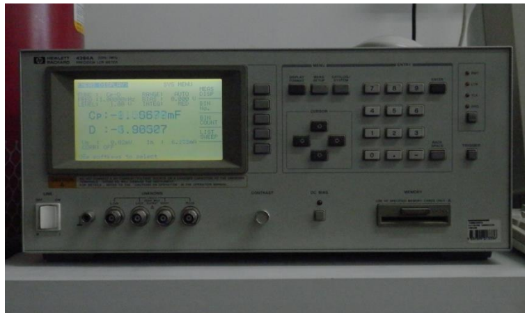
Figura 4.5. Fotografía del impedacímetro Hewlett Packard 4284A utilizado para determinar la respuesta eléctrica del \text{BaSnO}_3 debido a la presencia de un gas (INTEMA – UNMdP/Argentina).
