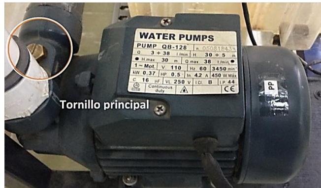
Figura 2. Vista superior de la motobomba mostrando el tornillo principal
