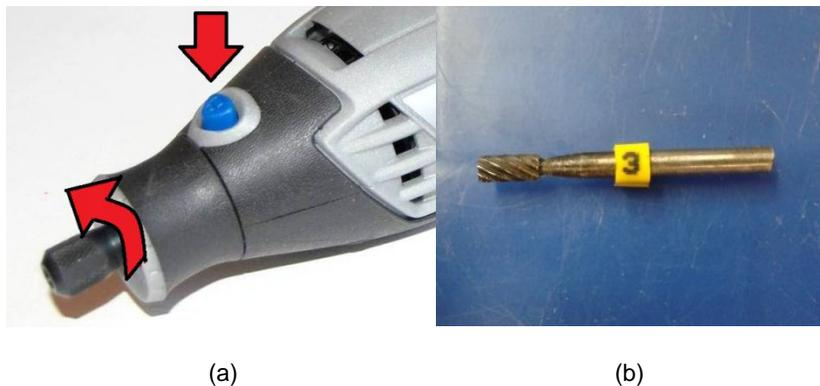
Figura 18. (a) Insertar fresa en el motor (b) Pieza cilíndrica número 3
