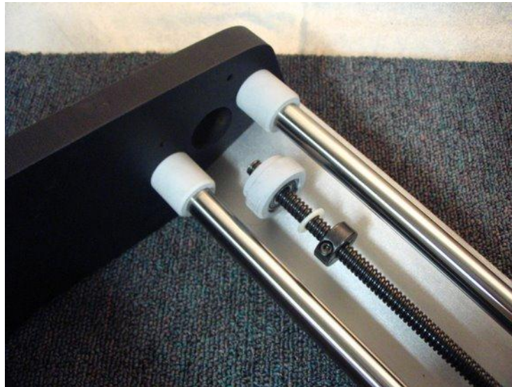
Figura D.10. Instalación extremo B del tornillo de avance
