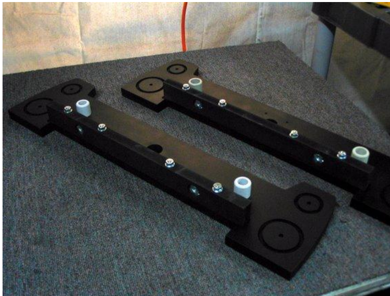
Figura D.17. Barra de soporte de mesa sujeta a bases
