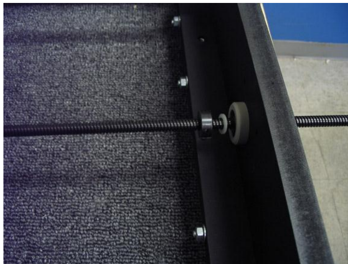
Figura D.28. Instalación del tornillo de avance largo
