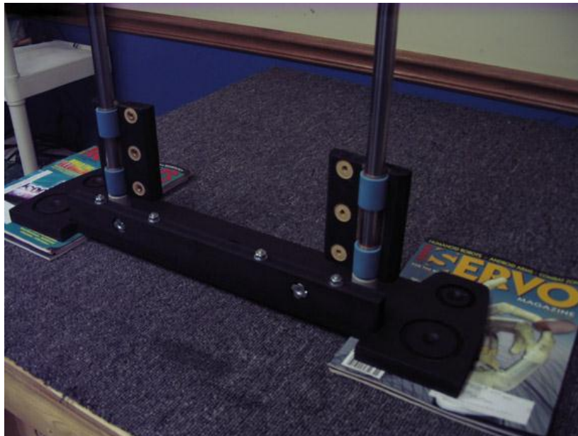
Figura D.20. Rieles ubicados sobre los finales de riel.
