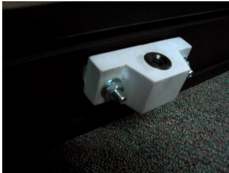
Figura D.12. Tuerca conductora inferior instalada
