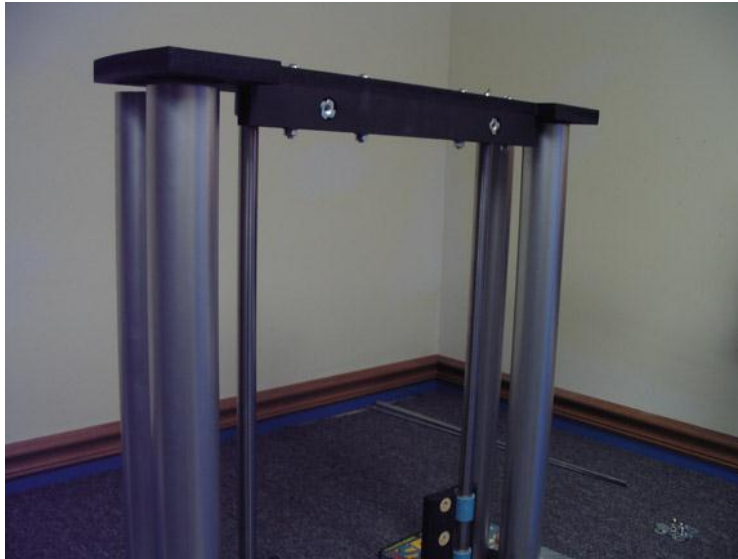
Figura D.22. Adecuación de la siguiente base lateral con tubo y rieles
