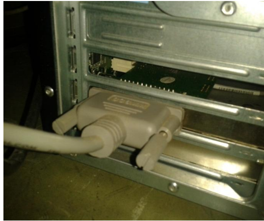
Figura 41. Conexión controladora al ordenador mediante puerto paralelo.
