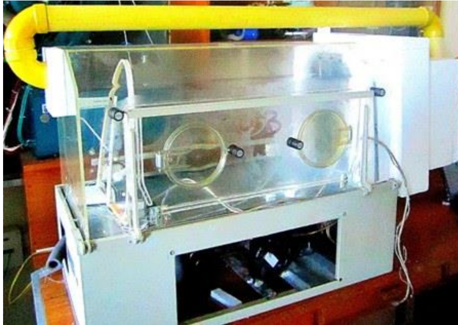
Figura 15. Instalación del tubo de circulación de aire
