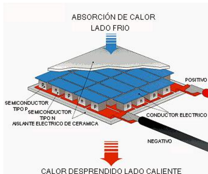
Figura 1. Sistema Peltier
