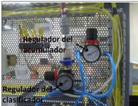
Figura C. 7 Regulador de presión del clasificador y regulador de presión del acumulador en el panel trasero del sistema de clasificación.
