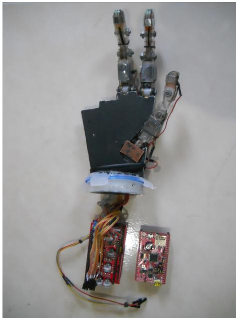
Figura 3.18: Tarjeta Fio Std separada de instrumentación de sensores y potencia.
