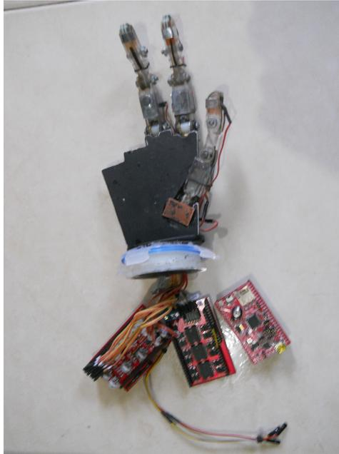
Figura 3.19: Tarjeta FiO Std, acondicionamiento señales de sensores y de potencia.
