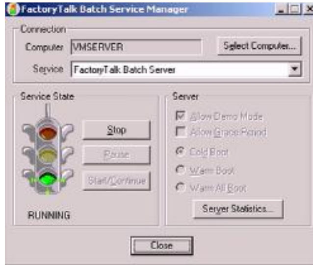
Figura 102. Servidor Batch en estado Running
