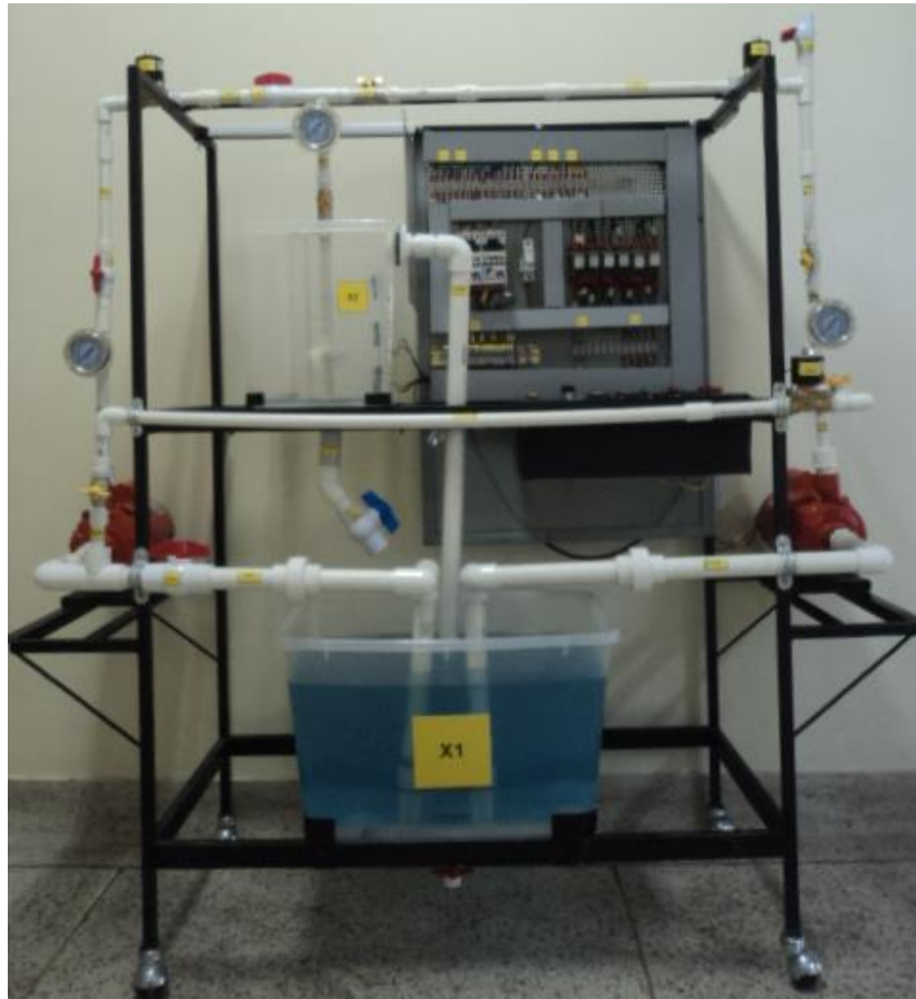
Figura 24 Banco de Pruebas para Bombas Centrífugas.
