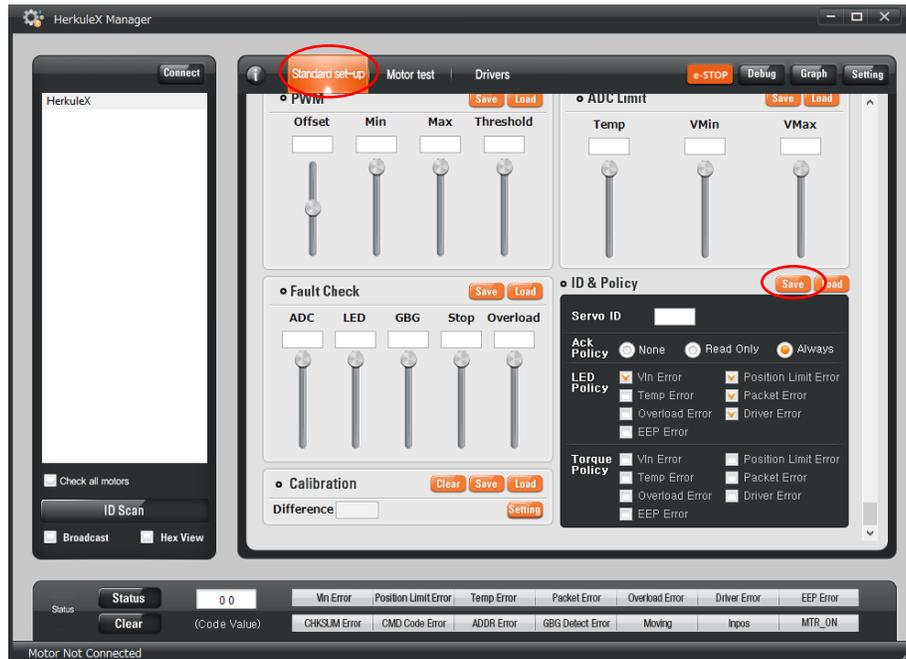
**Figura 29. Configuración política-torque de los servomotores**
