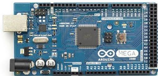
**Figura 4. 21 Tarjeta ATmega2560.**
