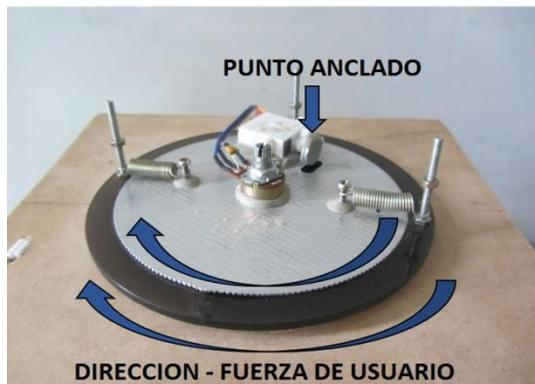
**Figura 4. 27 Dirección de las fuerzas que actúan en ausencia de colisiones.**
