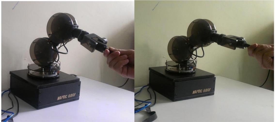
**Figura 6. 15 Puntos de orientación en el eje z – HAPTIC 6DOF**
