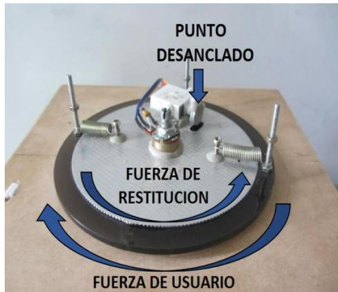
**Figura 4. 28 Dirección de las fuerzas que actúan con colisión.**
