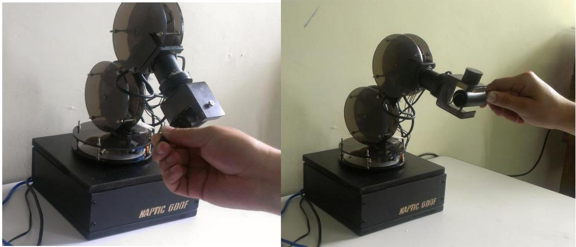
**Figura 6. 11 Puntos de orientación en el eje x – HAPTIC 6DOF**
