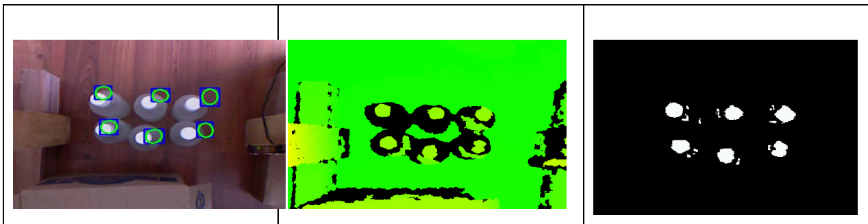
Figura 26. Izquierda: Imagen RGB, Centro: Imagen de Profundidad, Derecha: Imagen binaria por segmentación de profundidad. Fuente propia.
