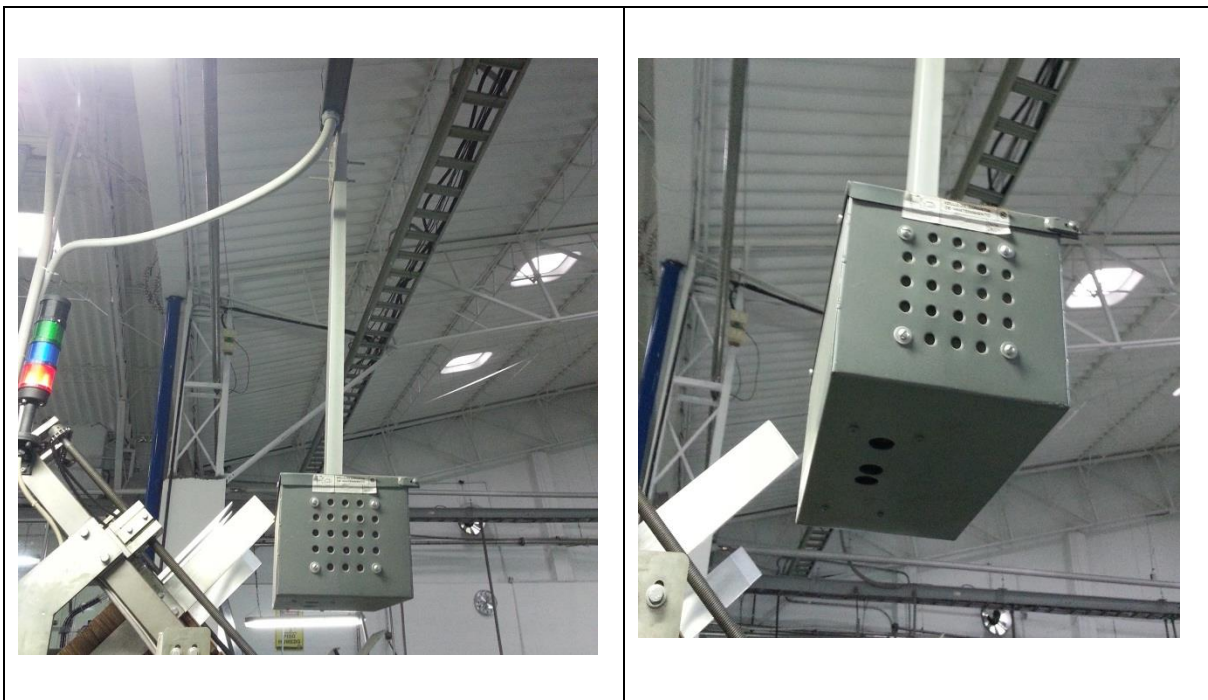
Figura 24. Housing de protección para el sensor Kinect. Fuente propia.
