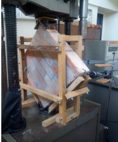
a) Vista frontal de montaje de compresión en murete
