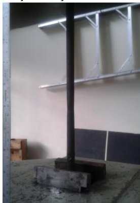
a) Varilla entre mordazas para ensayo de tensión
