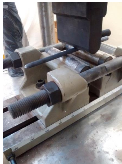
b) Vista cercana a montaje de flexión
