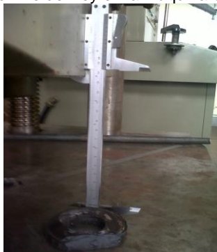
Figura 46 Toma de datos con calibrador Pie de Rey en la máquina Shimadzu
