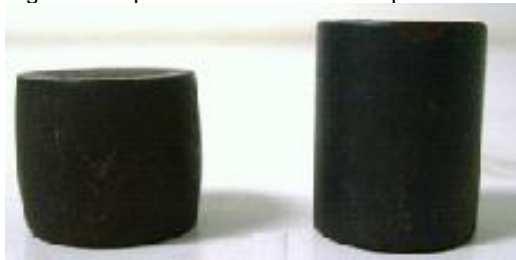
Figura 23 Tipos de fracturas en compresión.
