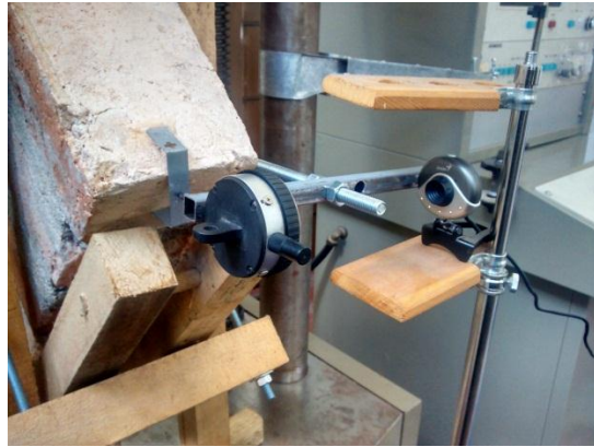
b) Vista cercana a montaje con cámaras en deformímetro para registro de datos
