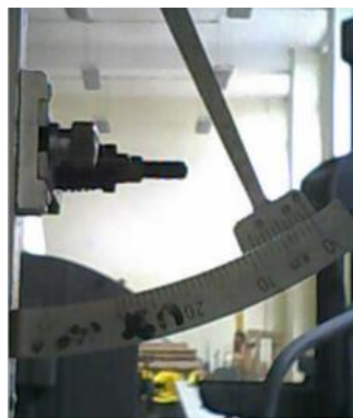
b) Deformimetro ubicado en la probeta para verificar desplazamiento
