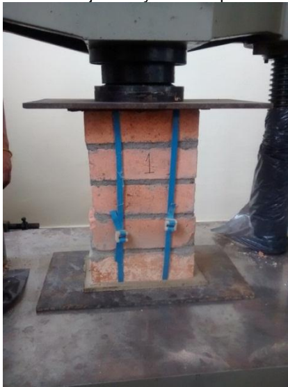
a) Vista frontal de montaje de prisma Fuente propia, abril de 2014
