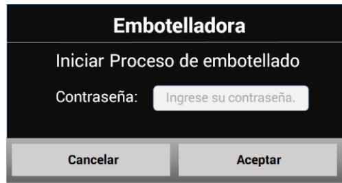
Figura 2. 56. Protección del mando. [Fuente: propia]
