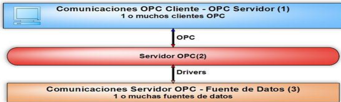
Figura 4. 2. Esquema de una Arquitectura OPC [Fuente: [59]]
