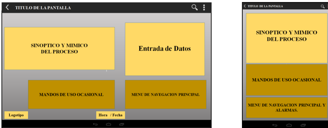
Figura 2. 40. Distribución de pantalla para un dispositivo móvil en orientación landscape (izquierda) y portrait (derecha). En esta última orientación, la entrada de los datos se realiza en otra ventana. [Fuente: propia]
