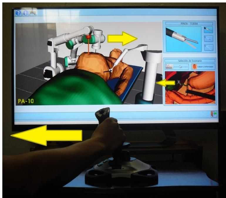
Figura 6-3. El efector final y el *joystick* se mueven hacia la izquierda.
