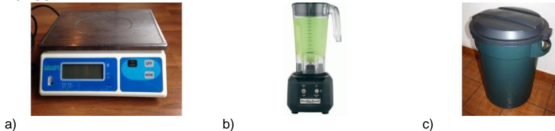
Figura 3. Módulos equipo para formulación de FORSU y mezclado de FORSU a) Balanza industrial JAVAR CW 15 b) Licuadora industrial JAVAR HBB250R de 15 litros c) Tanque de almacenamiento FORSU
