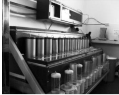
Figura 7. Unidad de biodegradación anaerobia
