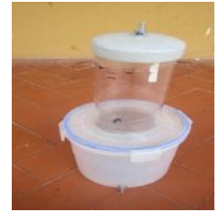
Figura 8. a) Tanque baño María, b) Tapa de vidrio, c) Bioreactor con tapa hermética, d) Acumulador de gas
