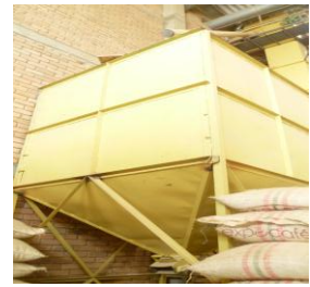
c) Tolva homogenizadora
