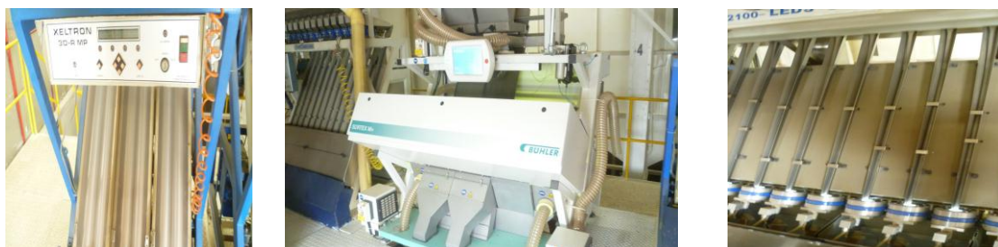
Figura 3-8 Máquinas electrónicas para la selección de café verde por visión de máquina.
