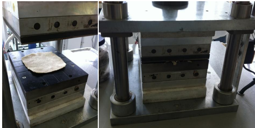
Figura 35. Desajuste del molde macho.
