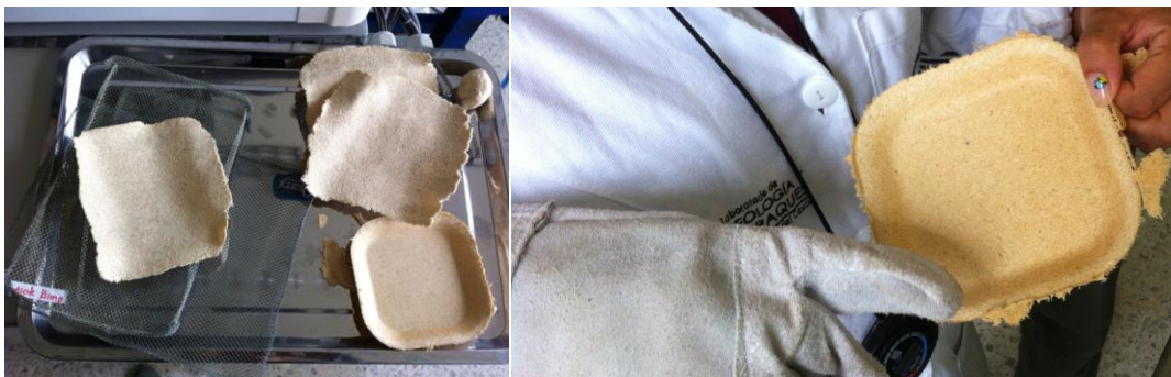
Figura 36. Resultados de la prueba de moldeo: Bandeja reseca.
