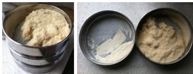
Figura 13. Tamizado del fique.
