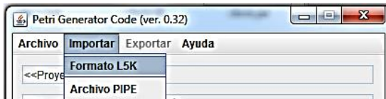
Figura 3.12 Importar proyecto de RsLogix5000 en PGC. Fuente: Propia
