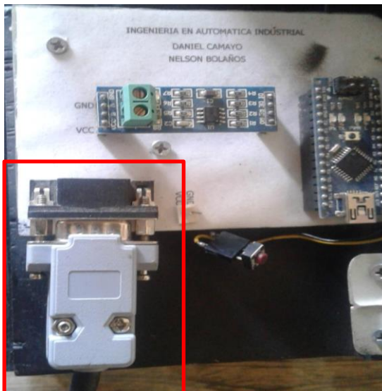
Figura 14 conexión cable utp cat 5 a modulo maestro
