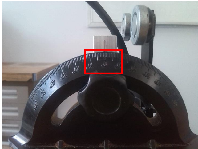
Figura 17 calibración sonda inclinometrica
