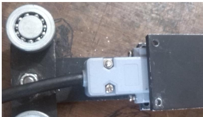
Figura 29 Conexión cable de comunicación con sonda inclinometrica
