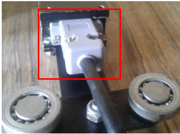
Figura 13 Conexión cable utp cat5 a inclinómetro
