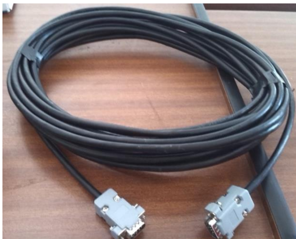
Figura 3.7 Cable utp categoría 5 con conectores DB9 macho
