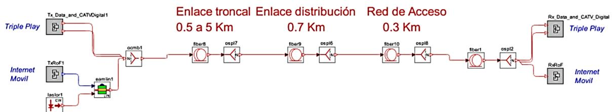
Figura 2.16. Modelo físico de la red FTTH-GPON *Quad Play* para 1 ONT.
