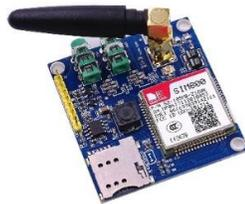
**Figura 7.** Módulo GSM SIM800.
