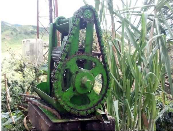
Figura 18. Transmisión por Cadena. Fuente Propia.
