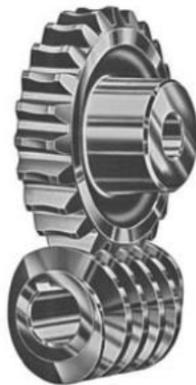
Figura 24. Tornillo Sinfín Corona. Fuente: R. L. Norton, 2011.
