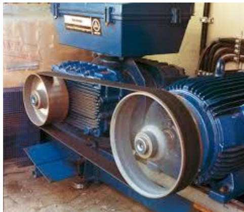
Figura 14. Transmisión por Correa Plana. Fuente: Catalogo Siegling Extremultus.
