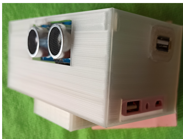
Figura 2.7: Caja PLA diseño 3D Test Salto de longitud pies juntos.
