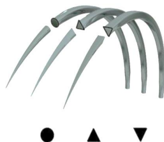
Figura 3.3: Agujas de sección cónica y triangular. Fuente: [50].
