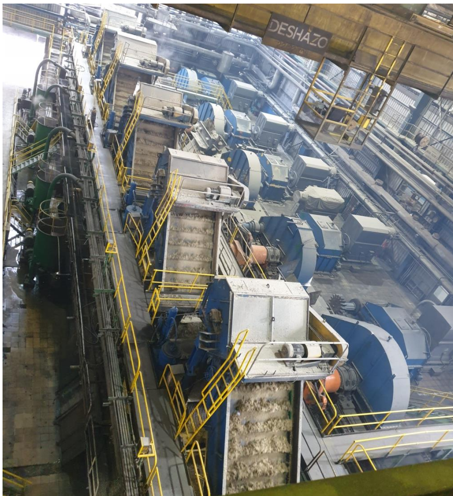
Figura 4. Proceso de Molienda (Tándem de molinos Fulton)
