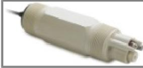
**Sensor de pH, montaje tipo unión, cuerpo de LCP (polímero de cristal líquido), 2 hilos con salida de 4 - 20 mA, electrodo de vidrio**
