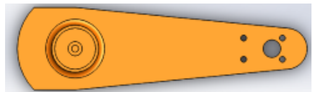
Figura 3.6: Eslabón 3. Vista superior Fuente: Diseño propio.
