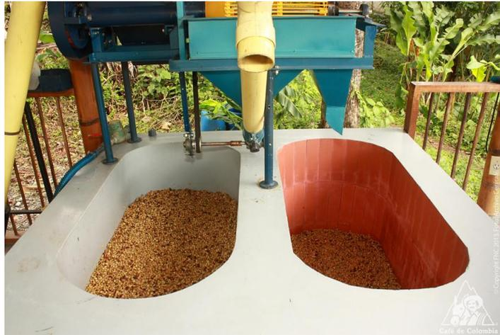
**Figura A.4.** Remoción del mucílago empleando tanques de fermentación. Tomado de [49].
