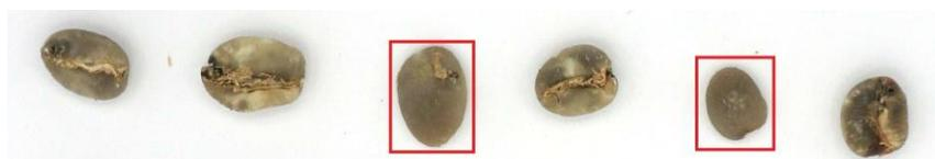
**Figura 4.11.** Clasificación fallida de granos con brocado leve. Fuente propia.
