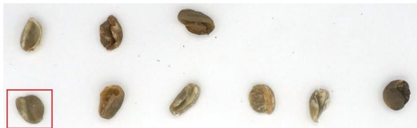
**Figura 4.10.** Clasificación fallida de granos con defecto concha. Fuente propia.
