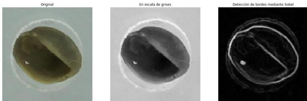
Figura A.29. Ejemplo de segmentación basada en bordes. Fuente propia.
