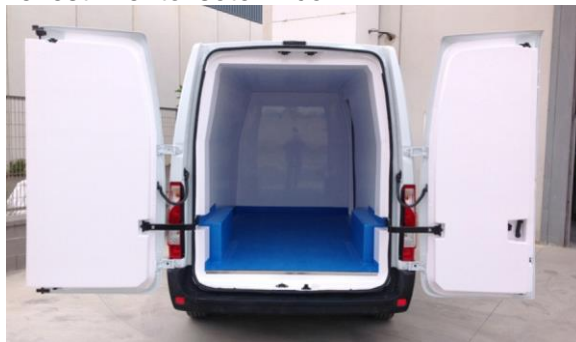
Figura 9. Vehículo con revestimiento isotérmico
