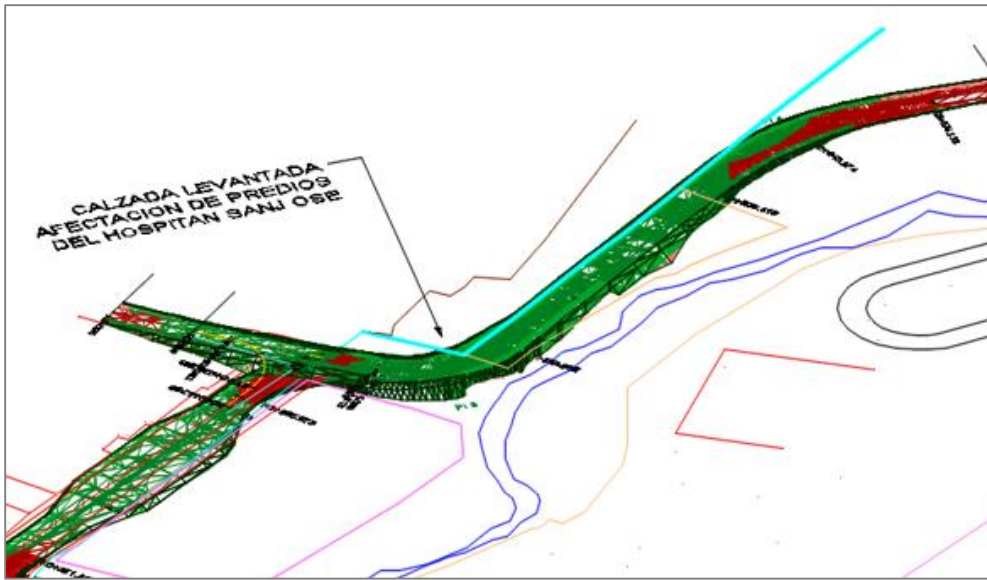
Ilustración 23 Calzada elevada con sección transversal reducida
