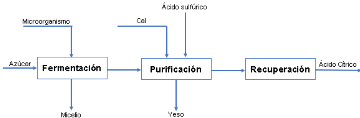
Figura 2. Esquema general del proceso de obtención de ácido cítrico
