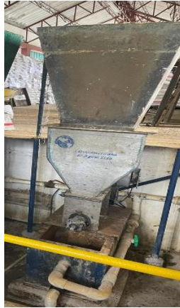
Ilustración 9. Maquina Dosificadora de Sulfato - Fuente propia.
