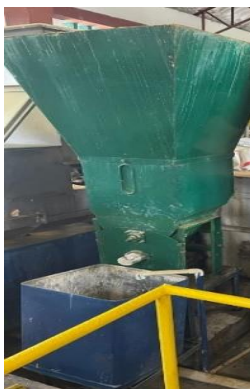
Ilustración 27. Dosificadora de Cal - Fuente propia.
