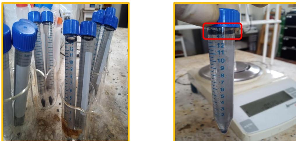
**Figura 2.6.** Separación por decantación entre CTG y carbón.
