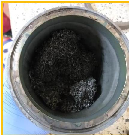
**Figura 2.5.** Carbón obtenido del proceso de pirolisis.
