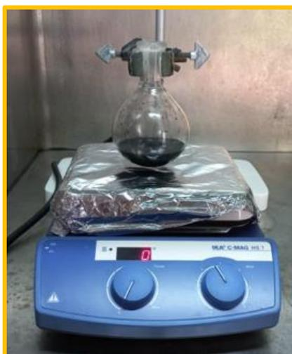
**Figura 2.7.** Montaje para emplear del método Hummers modificado para la obtención del OG.
