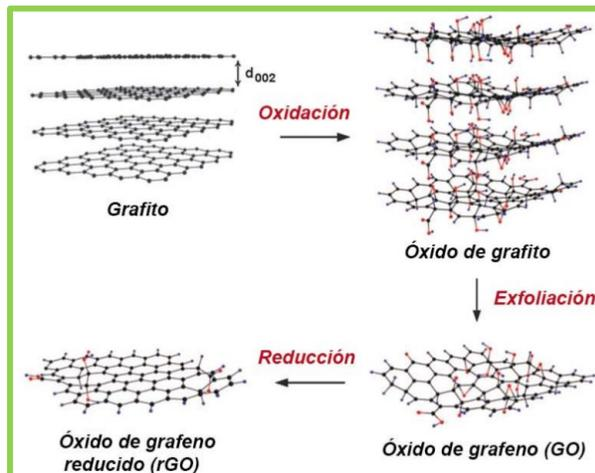
Figura 1.7. Obtención y estructura del oxido de grafeno [23].
