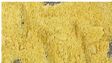
Figura 13. Textura del compuesto de cinc obtenido por síntesis verde, usando extracto de ajo, y tomando como base el método de precipitación controlada.
