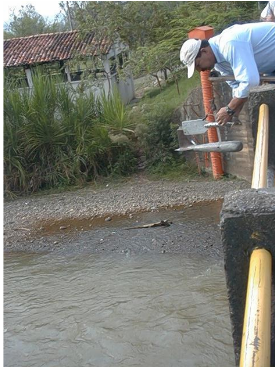
Procedimiento de suspensión correntómetro más lastre C.V.C, (Pte. sobre Río Timba).
