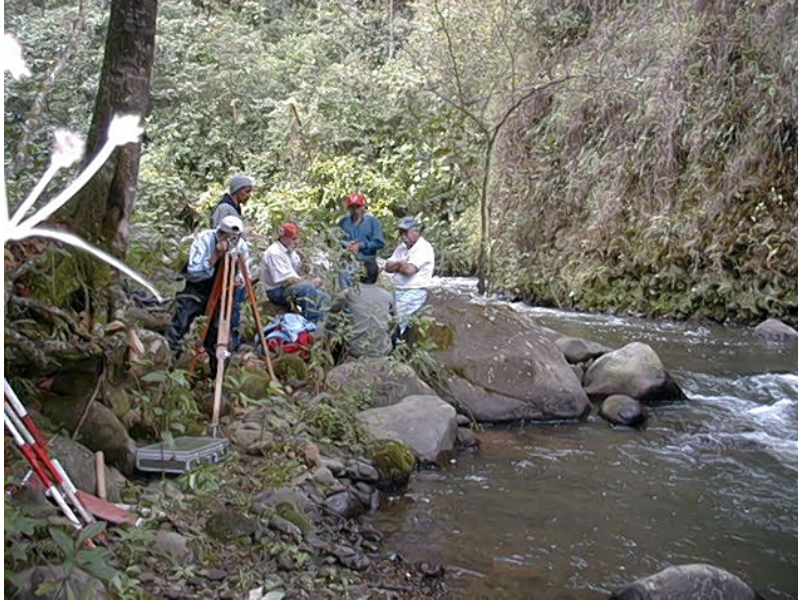
Lectura de desnivel superficie del agua, utilizando nivel de precisión (Río Cofre).
