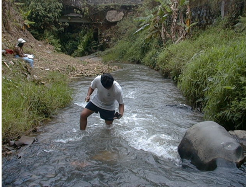
Medición de los ejes de una partícula del lecho (Río Salado).
