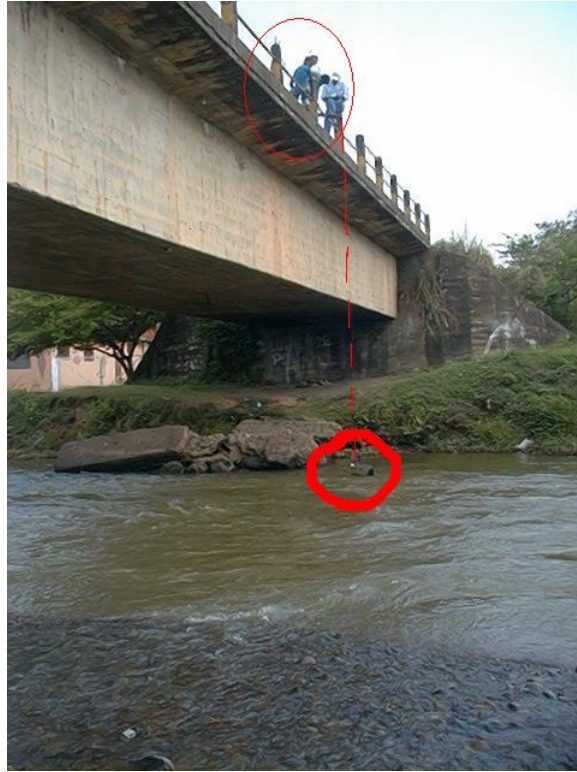
Procedimiento de aforo correntómetro suspendido más lastre C.V.C. (Pte.; Río Timba).
