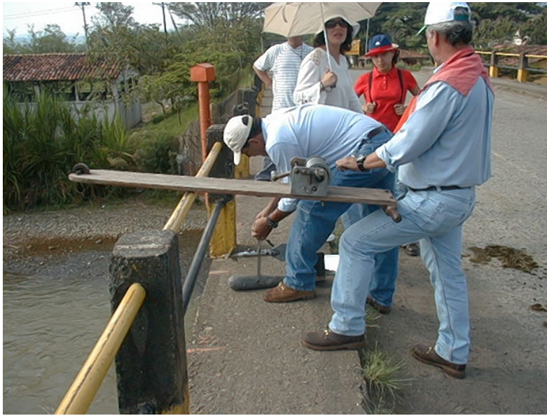
Equipo de suspensión correntómetro más lastre C.V.C, (Puente sobre Río Timba).
