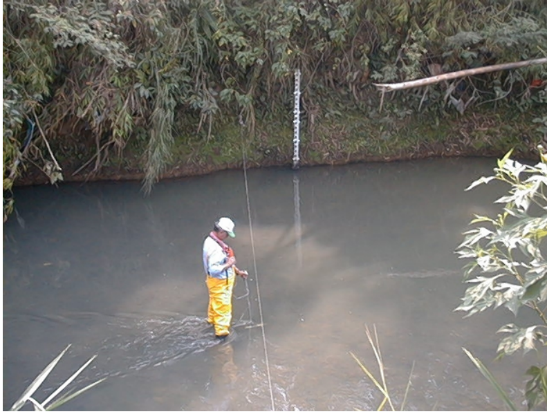
Mediciones efectuadas en el Río Jamundí; correntómetro C.V.C.
