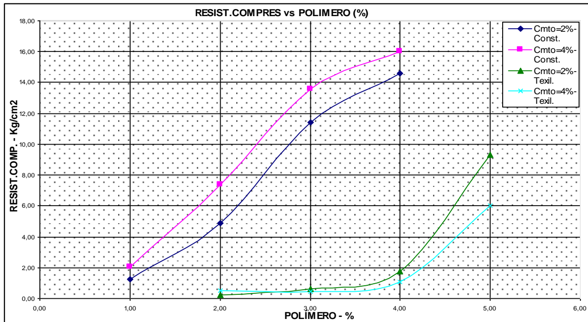
Figura 4. Variación de la resistencia a la compresión para diferentes contenidos de cemento y polímero – cubos estandarizados – 28 días
