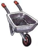
**Buggy o Carreta:** Equipo utilizado para el traslado de materiales, consta de un platón plástico o metálico; una rueda de caucho, dos manijas para su conducción y dos patas para su soporte.
