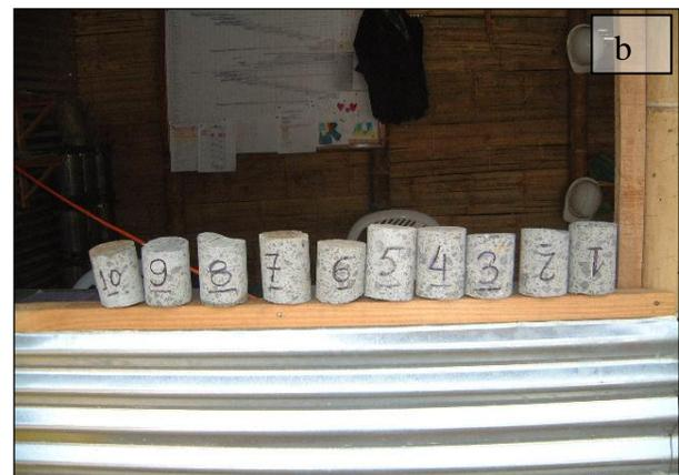
Imagen 4.05 a) Extracción de núcleos para medir el espesor de la placa, b) Variabilidad en el espesor de los núcleos extraídos.
