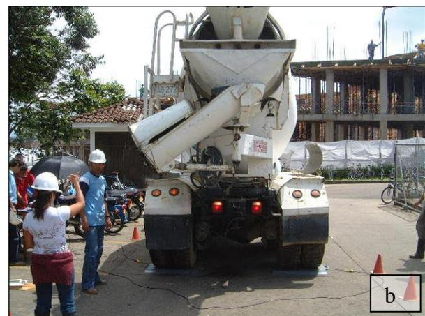
Imagen 4.06 a) báscula portátil para el pesaje de camiones, b) Operaciones de pesaje de un camión transportador de concreto.
