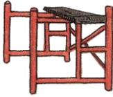
**Andamio:** estructura o armazón de metal o madera, que facilita el trabajo en lugares altos, de difícil alcance para la altura del trabajador.
