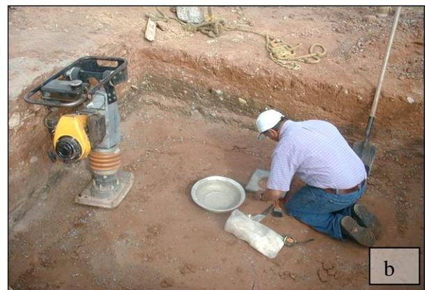
Imagen 4.03 a) Escombros encontrados en las excavaciones del bloque A, b) Ensayo del cono de arena para medir la densidad.
