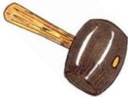
**Mazo o “Chapulin”:** Herramienta para golpear, generalmente con cabeza de caucho y mango en madera. Utilizado en construcción para vibrar el concreto, golpeando la formaleta, se utiliza también para la pega de enchapes.
