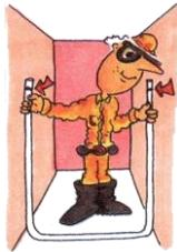
**Nivel de manguera:** manguera plástica transparente empleada para pasar niveles por medio del sistema de vasos comunicantes, la manguera utilizada debe ser de un diámetro de 1/4 a 3/8” de pulgada, (NO deben formarse burbujas en la manguera).
