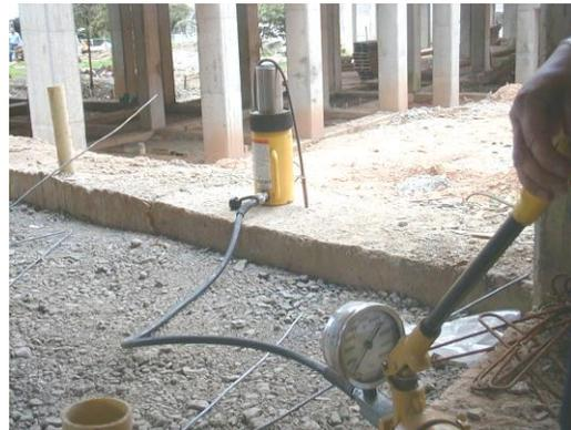
Ilustración 14 Gato hidráulico, ensayo anclajes
