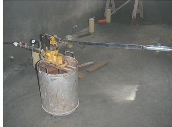
**Ilustración 54 Recipiente con tinta roja para prueba de estanqueidad**
