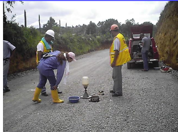
Foto No 59 Toma de densidades de campo, capa de base.
