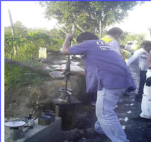
Foto No 61. Elaboración de briquetas para control de mezcla asfáltica.
