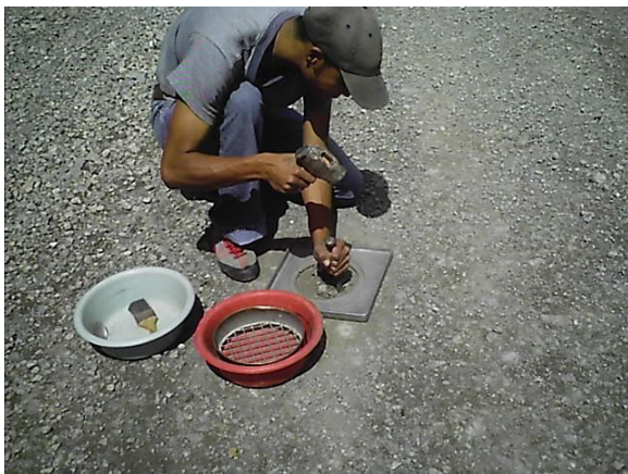
Foto No 58 Toma de densidades de campo, capa de base.
