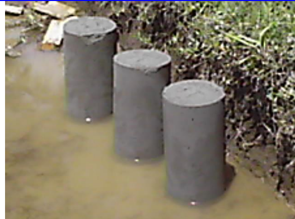
Foto No 57 Forma incorrecta de curar cilindros de concreto.
