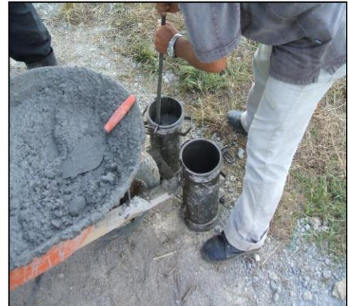
Foto 15. Toma de muestra de concretos.
