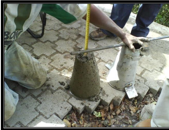
FOTOS No 15 Y 16, TOMA DE MUESTRAS PARA ENSAYOS DE FLUIDEZ Y PRUEBA DE CARGAS
