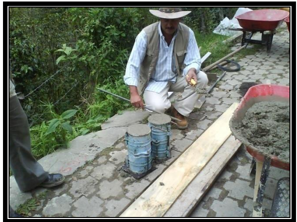
FOTOS No 15 Y 16, TOMA DE MUESTRAS PARA ENSAYOS DE FLUIDEZ Y PRUEBA DE CARGAS
